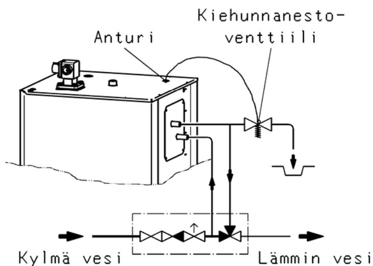
Рис. 2 Подключение термического клапана к змеевику ГВС котла
