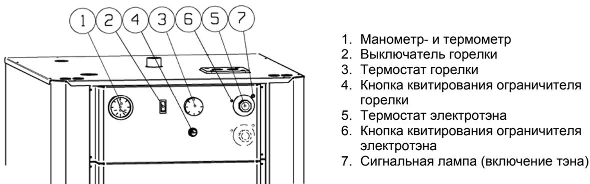
1. Манометр- и термометр
