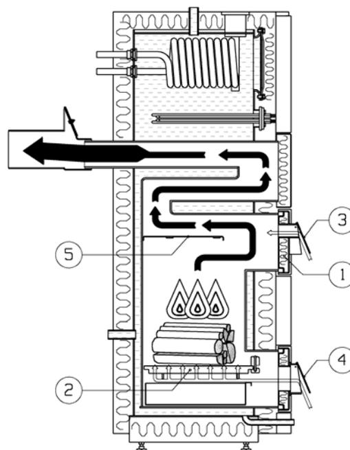
Рис. 5 Котел при эксплуатации на твердом топливе
